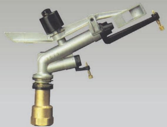
**Irrigatore di piccola e media portata** disponibile in due versioni, a giro completo e a settori regolabili. I due getti, diversamente inclinati, sono muniti di ugelli intercambiabili e di rompigetti regolabili in modo da ottenere precipitazioni fini e localizzate a piacimento. Per la sua versatilità è adatto per terreni e colture di qualsiasi natura e sistemazione.
